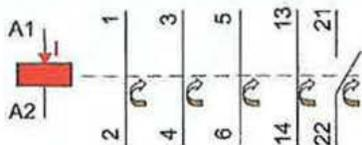
Figura 7.7. Representación gráfica del contactor activado.
